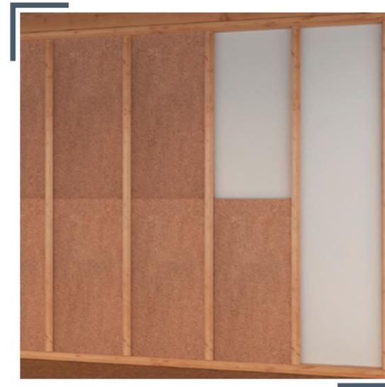
1 Pose des montants bois, conformément aux DTU 31.2 et 25.41
