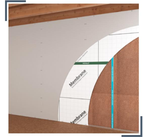
8 Lorsqu'un espace technique est nécessaire, il convient de réaliser une ossature spécifique rapportée à l'aide de profilés métalliques ou bois
