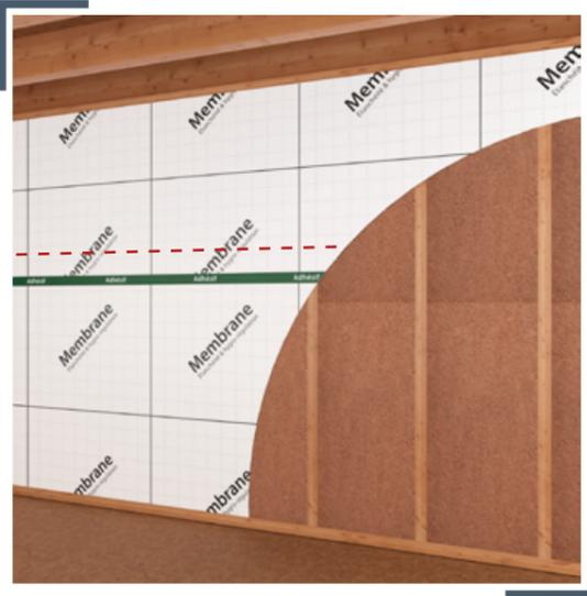
**1b** Mise en place de la première couche d'isolant Flex entre montants bois
