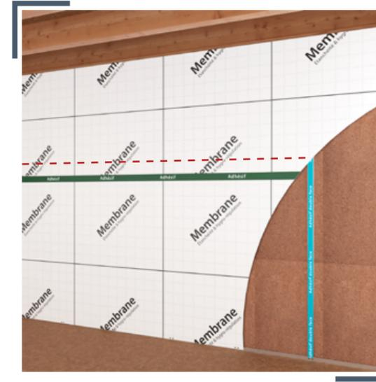
7 Pose de la membrane<sup>3</sup> sur les fourrures à l'aide d'un adhésif double face :
